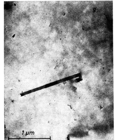
Abb. 5. Veränderung von Wachstumszwillingen in einer Gold-Einkristallschicht beim Aufheizen im Elektronenmikroskop. Durch die Verbiegung der Folie bei höherer Temperatur können die einzelnen Zwillinge auf den einzelnen Bildern teilweise mit verschiedenem Kontrast beobachtet werden.
